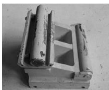
a) Condições de apoio (rolete metálico)
